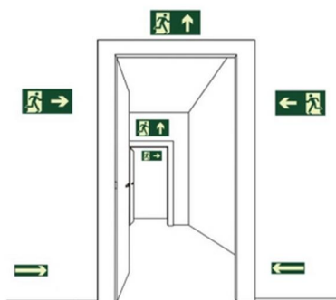
Figura 5: Exemplo de instalação de Placas de Sinalização acima da porta e na parede (REF. NBR 13434-2)
